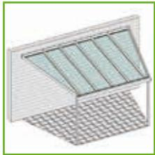
Pultdach mit schräg hochlaufenden Trägern
